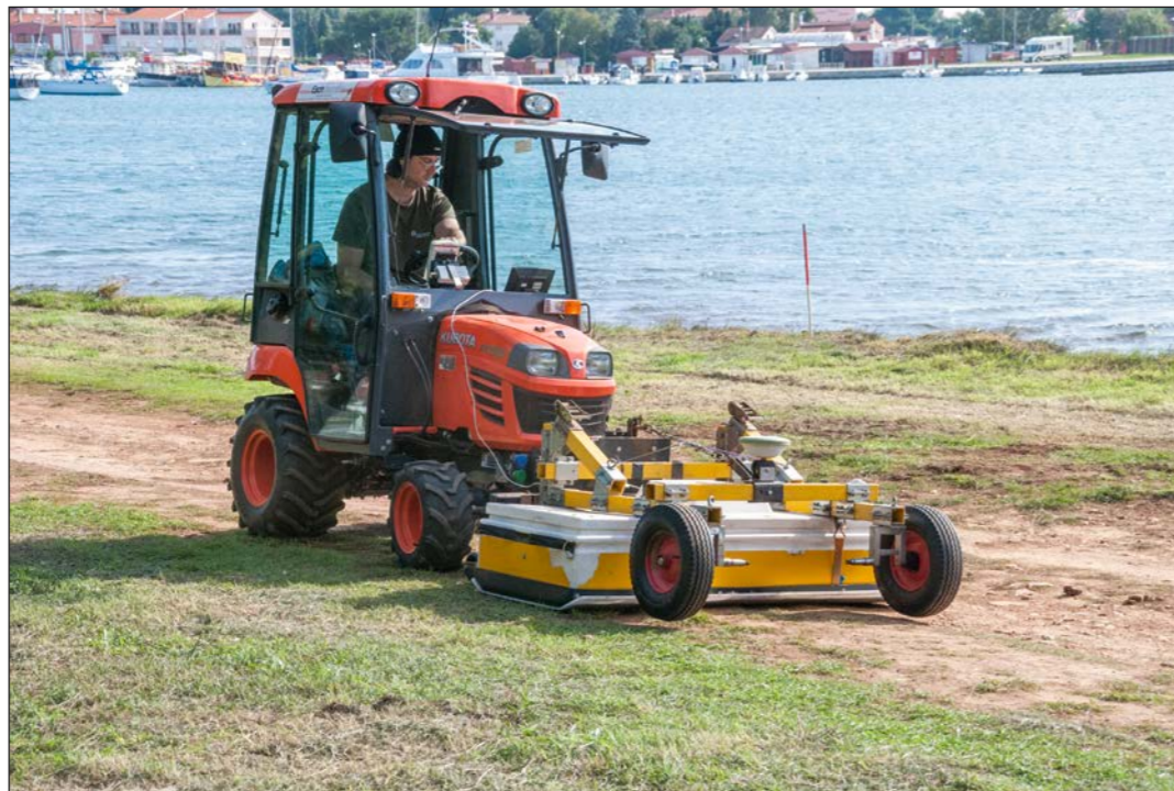
Istraživanja se vrše georadarom - nedestruktivnom metodom
